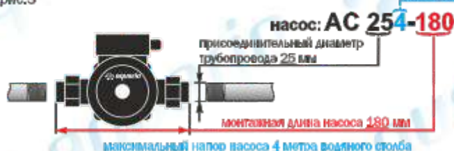
рис.3 Расшифровка названия модели циркуляционного насоса
